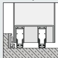
Упорная планка с уплотнением и 2 опускаемых напольных уплотнения
