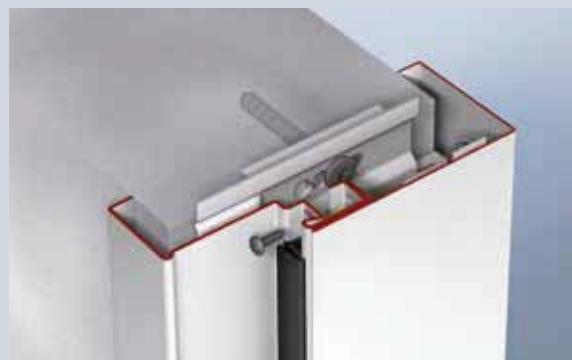
Через канавку для уплотнения соединить винтами
